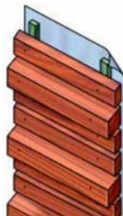
Afbeelding 3 - Horizontale open gevelbekleding met variabele afmetingen, trapeziumvormig voor goede afwatering.
