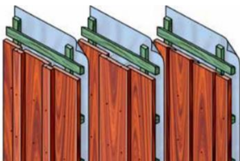
Afbeelding 4 - Verticale gevelbekleding V.l.n.r. opdekwerk, opdekwerk en rabat met halfhoutse overlap (channelsiding).
